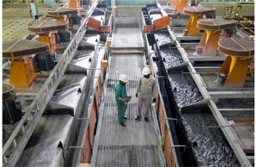
La majeure partie des produits ajoutés est partie avec le spath fluor expédié; une autre partie est dans les stériles mis en tas, une troisième est partie dans les mousses de l'eau du traitement et a été décantée.
